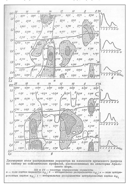
Наличие зоны повышенных значений  $\alpha_{Ei}$ , ориентированной вертикально и пересекающей все числовые поля, возможно обусловлено резким изменением поглощающих свойств в придонной части разреза. С целью ослабления влияния придонных факторов на более
