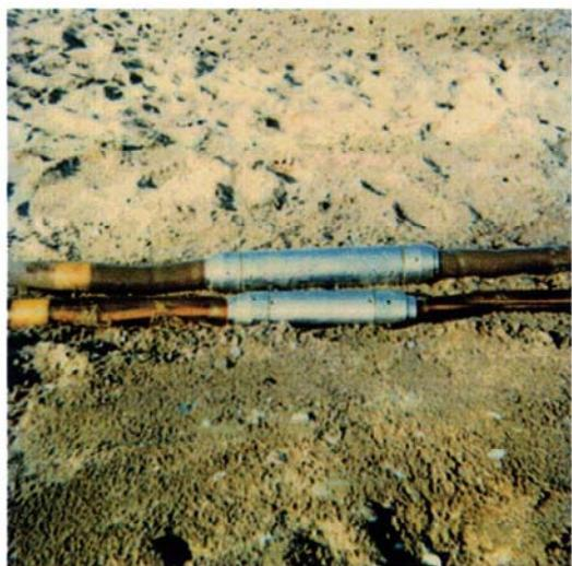
Рис. 3 Кабельно-модульные многомпонентные приемные системы
