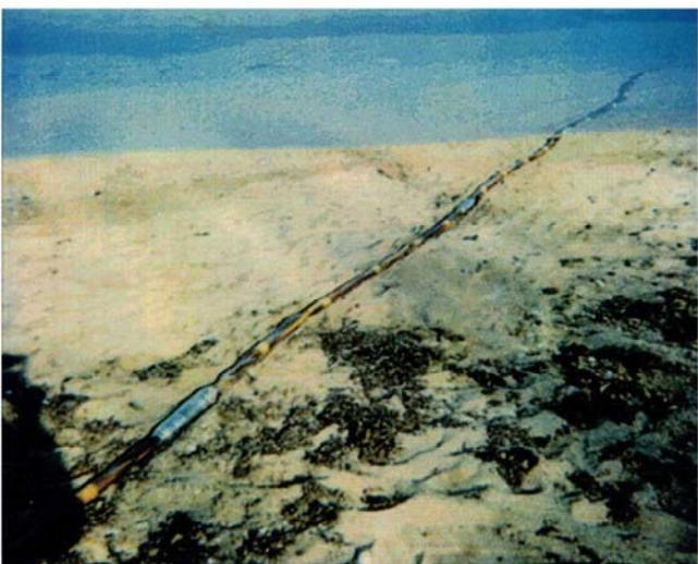
движении судна вдоль профиля (так называемый старт-стопный режим, при котором приемная система, отставая от судна, укладывается на донный грунт и после цикла "взрыв-запись" догоняет его при помощи скоростной подмоточной
